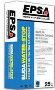
**TANIMI:** Çimento esaslı, belirli oranda sadece su ile karıştırılarak tatbik edilen, eski ve yeni yapılarda yüzey sularına karşı beton donatıda negatif ve pozitif yönlü kullanılabilen, yüzeyin kapiler boşluklarına transfer olup orada genişlererek su geçirimsiz tabaka oluşturan kristalize su izolasyon malzemesidir, başka bir ifade ile toz membrandır.
